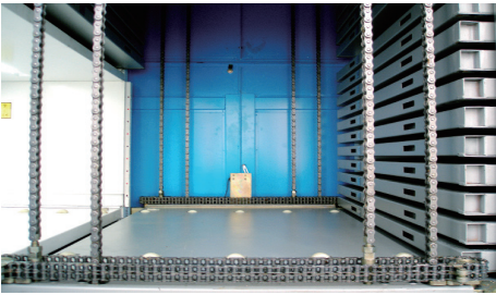
四链条悬挂系统 Four chains suspension system
